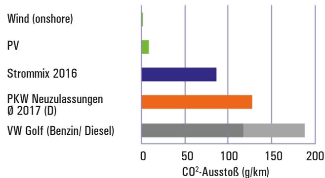
CO<sub>2</sub>-Emissionen nach Antriebsenergie. Ausstoß eines Elektrofahrzeuges (16kWh/100km) gemäß zusätzlich errichteten erneuerbaren Stromquellen (in grün) oder deutschem Strommix (in blau) im Vergleich zum Durchschnitt der Neuzulassungen 2017 (in orange) und exemplarisch diverser aktueller VW Golf Modelle (in grau).
