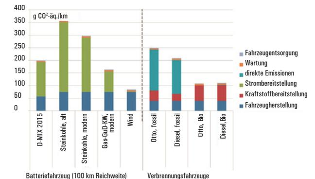
Vergleich der Klimabilanz von batterieelektrischen und konventionellen Fahrzeugen ermittelt pro km bei einer Lebenslaufleistung von 168.000 km
